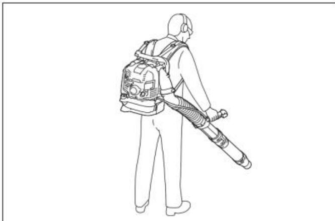
1. Durante el funcionamiento del soplador, ajuste el gatillo del acelerador de manera que la fuerza del viento sea la adecuada para el lugar y las condiciones de trabajo.
